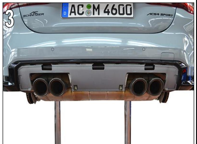
Fig. 3 Déclipsez l'insert de jupe arrière standard sur tout le pourtour et retirez-le vers l'arrière.
